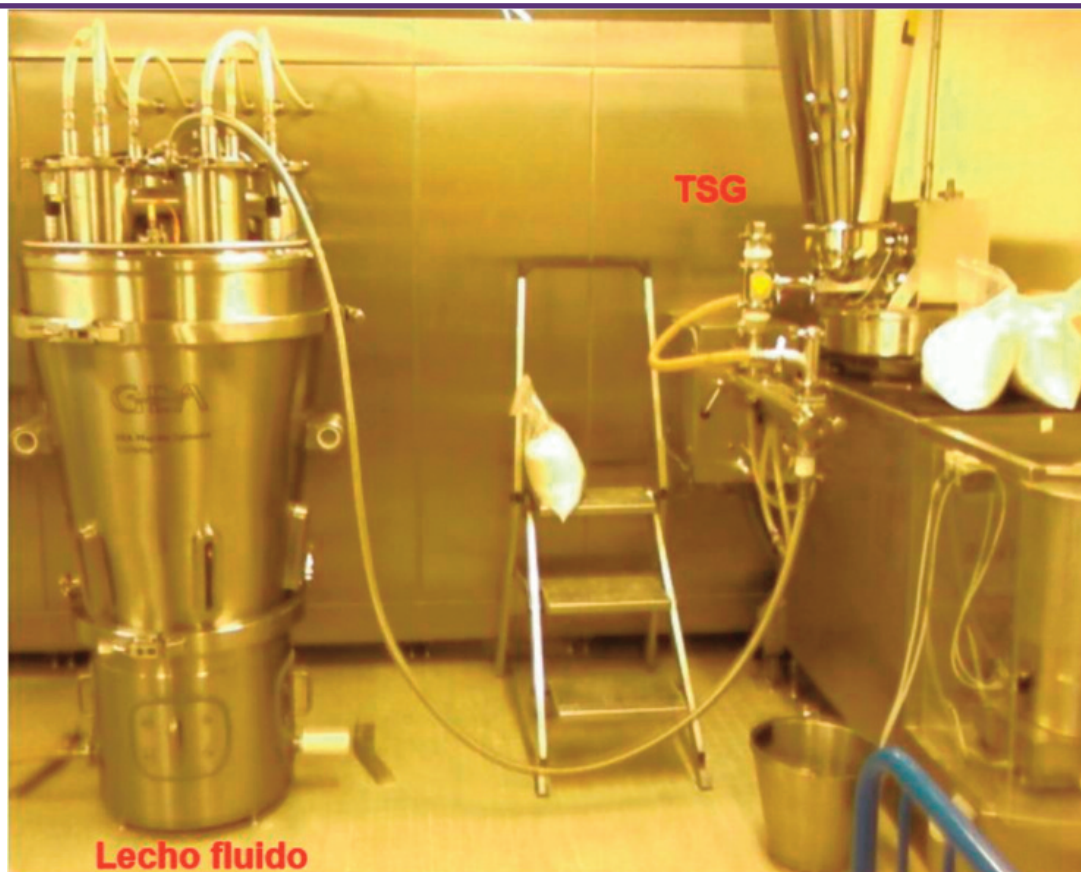
Fig. 2: Detalle de la línea ConsiGma 25 empleada en el estudio. A la izquierda se observa el lecho fluido de seis segmentos y a la derecha, conectado por vacío, el TSG equipado con una única tolva de alimentación de mezclas.
