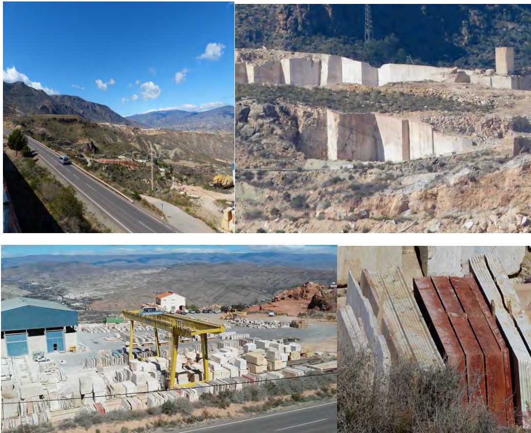
Figura 10. Arriba a la izquierda, plataformas de travertinos que se forman en la margen oriental de la Sierra de Gádor; a la derecha, una de las canteras de las que se extraen los bloques de travertinos. Abajo, izquierda, fábrica de trasformación de los bloques en láminas; a la derecha, diferentes láminas de espesores y colores diversos, dependiendo del contenido en hierro de las aguas que han dado lugar a travertinos.
