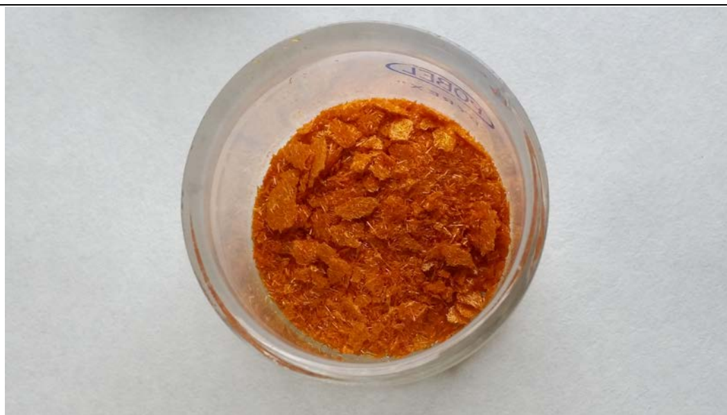
Figura 1. Curcumina recrystalizada en etanol-agua (fotografía UNED).
